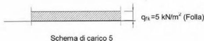
Schema di carico secondo D.M. 14-01-2018
